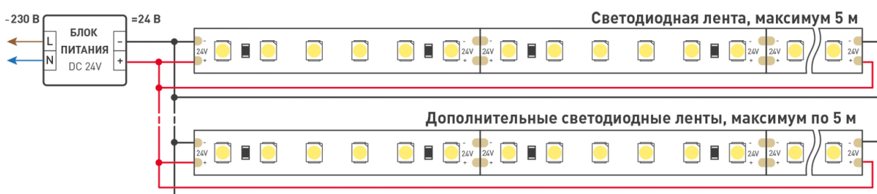
Схема 2. Подключение нескольких светодиодных лент с двух сторон.
