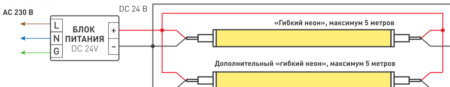
Схема 1. Подключение «гибкого неона»
