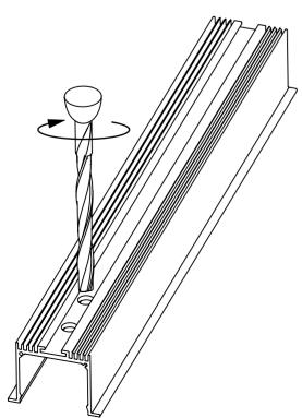
В просверленное отверстие установить монтажный крепеж как показано на рисунке:
