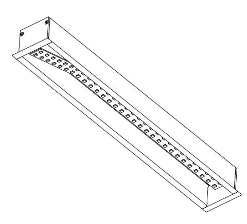
Установить в профиль рассеиватель. Светильник готов к использованию:
