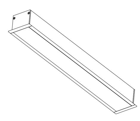
Профиль и рассеиватель допускается нарезать в требуемый размер. Электрическое подключение системы длиной 2,5м и более см. в документации на светодиодную ленту.
