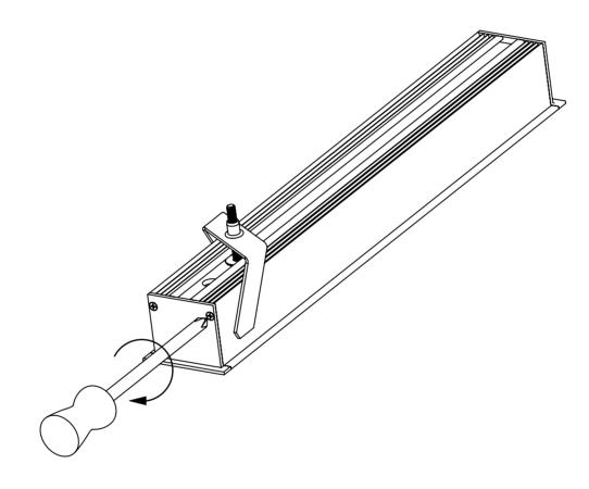
Установить профиль в монтажное отверстие. Вывести провод электропитания от драйвера через отверстие (п.3). Для защиты провода использовать кембрик:
