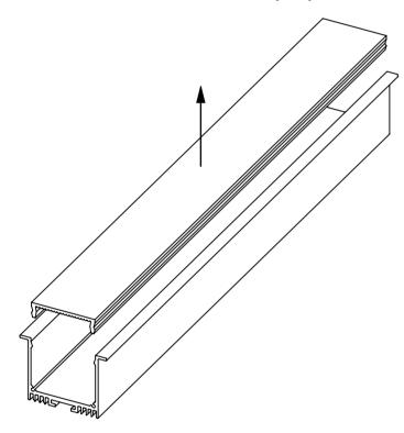
Через каждые 600мм по длине профиля просверлить отверстия ∅8мм под монтажный крепеж. Просверлить отверстие ∅8 мм под ввод электропитания от драйвера:
